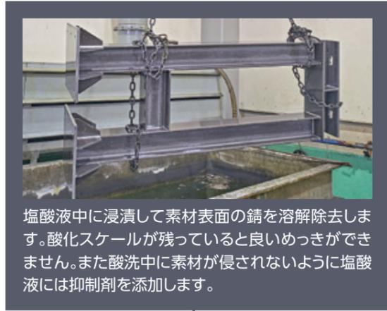
塩酸液中に浸漬して素材表面の錆を溶解除去します。酸化スケールが残っていると良いめっきができません。また酸洗中に素材が侵されないように塩酸液には抑制剤を添加します。
