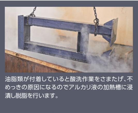
油脂類が付着していると酸洗作業をさまたげ、不めっきの原因になるのでアルカリ液の加熱槽に浸漬し脱脂を行います。
