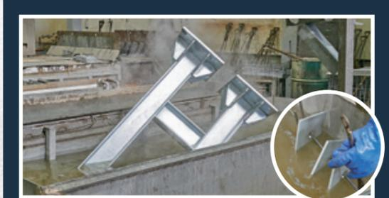
白さび防止槽に浸漬することによりめっき後の『白さび』を防ぎます。当社では座金類から大型の製品まで白さび防止処理を施しています。
