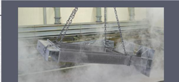
塩化亜鉛アンモニウムの溶液に浸漬し、フラックス処理を行います。これによって酸洗後に生成した素材表面の酸化物や酸洗で除去できなかった微量の酸化物を除去すると共に、めっき時の鉄と亜鉛との反応を促進させます。
